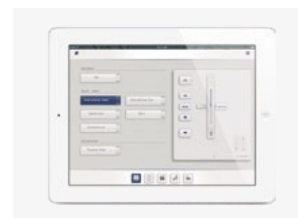
KNX / gBUS Steuerung per iPad
